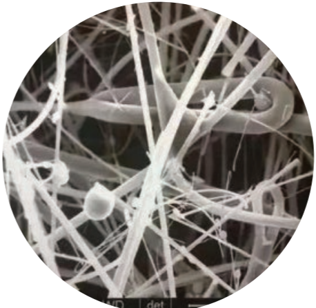
Nanopham 深层过滤材料的内部结构
